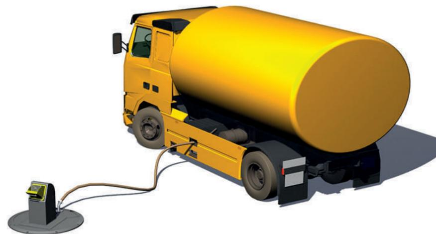
Collecte par aspiration par le tuyau connecté au camion de pompage.
