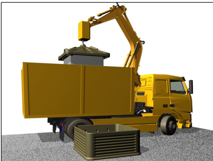
Vider le contenu des déchets de l'ECOTAINER dans la benne
