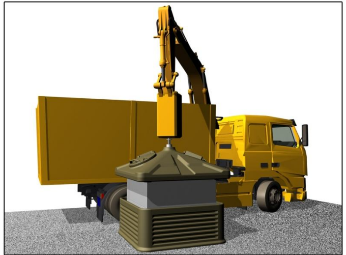
Lever l'ECOTAINER vers la benne
