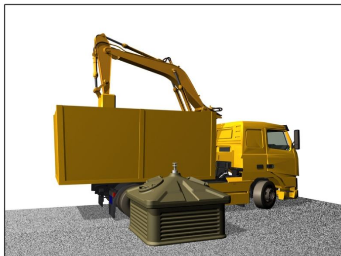
Vider le contenu des déchets de l'ECOTAINER dans la benne
